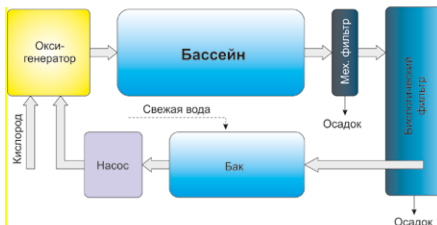
Рисунок 2 - Общая схема установки замкнутого водообеспечения
