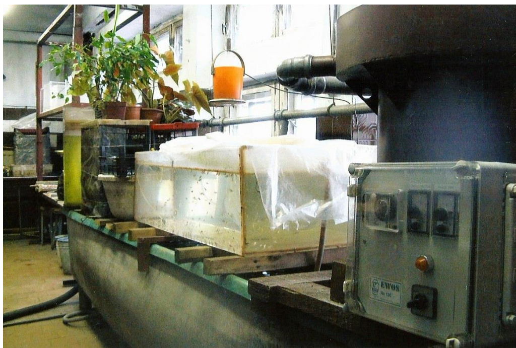
Рисунок 9 - проточный аквариум объемом (65 л), включенный в систему водоподготовки УЗВ
